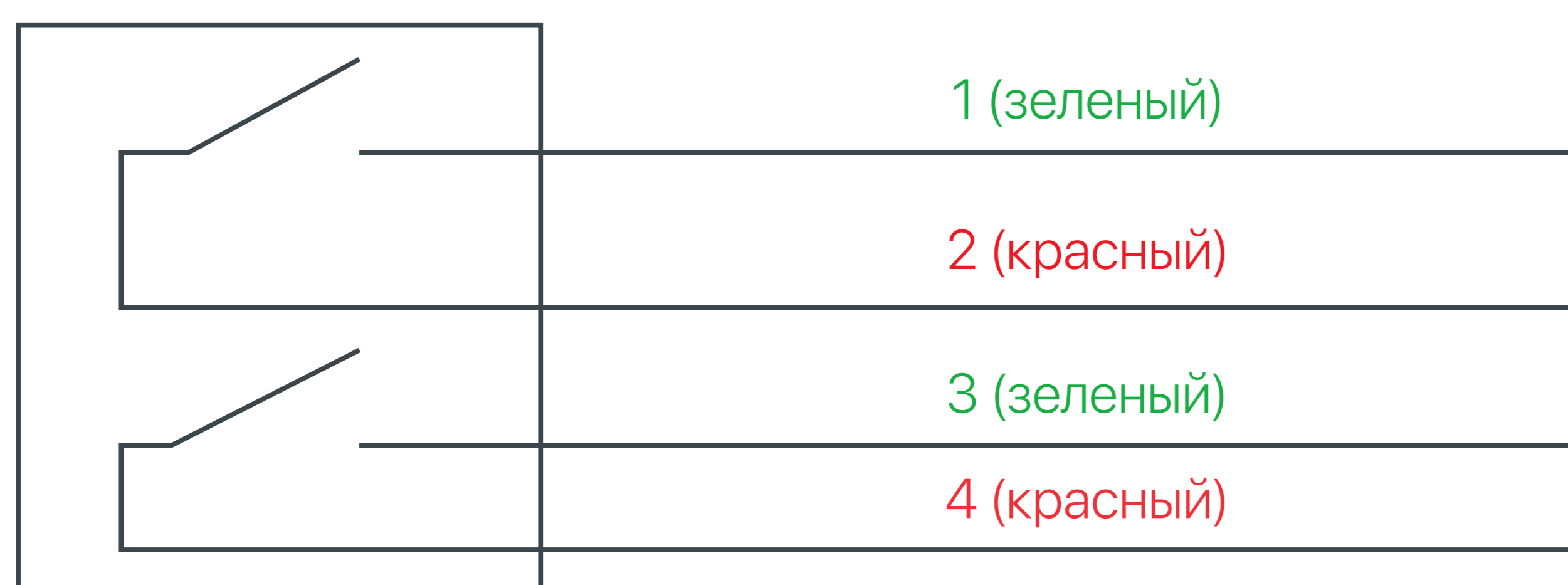
Рисунок 2. Схема подключения сигнализатора давления.
